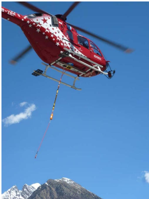
Abb. 1: kürzeste Länge ohne Last. Y-Rope, Dämpfer und Streckenlast
