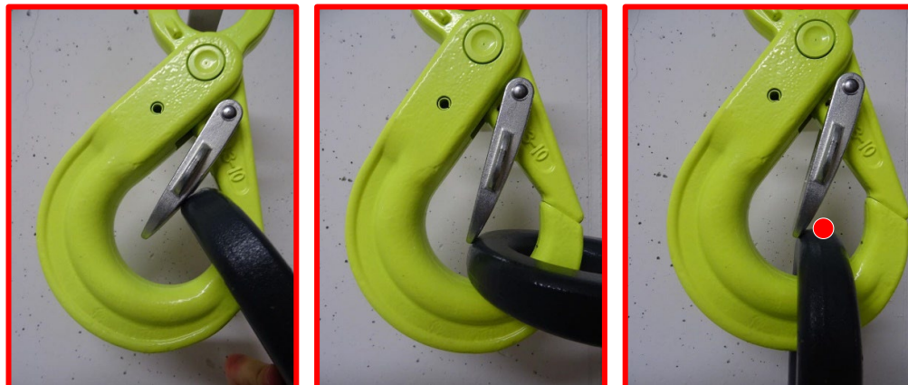
Fig. 15 – 17: Uso inappropriato! Se si chiude il gancio subito dopo aver inserito l'accessorio nero, la 2a linguetta di sicurezza non potrà più essere chiusa correttamente.
