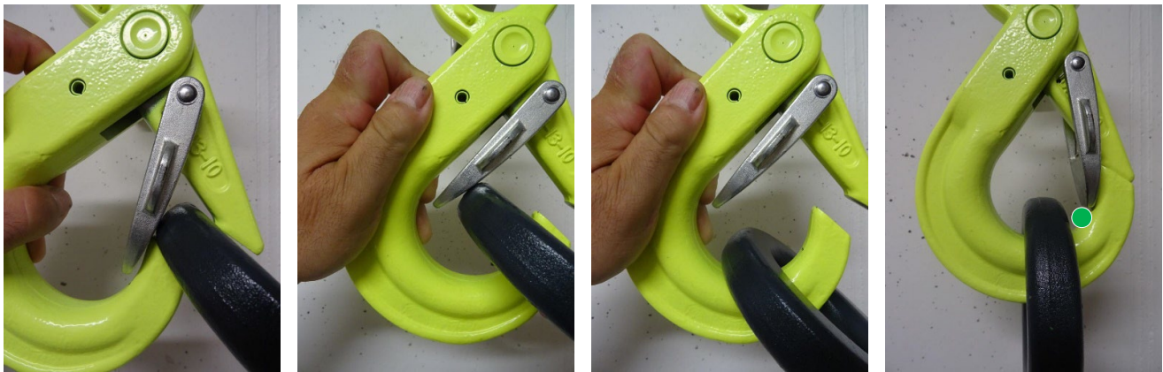
Fig. 11 – 14: Aprire il gancio e inserire l'accessorio/la redancia. Inserire completamente l'accessorio nero tenendo aperto il gancio. L'accessorio è correttamente posizionato solo quando la 2a linguetta di sicurezza è completamente chiusa.
