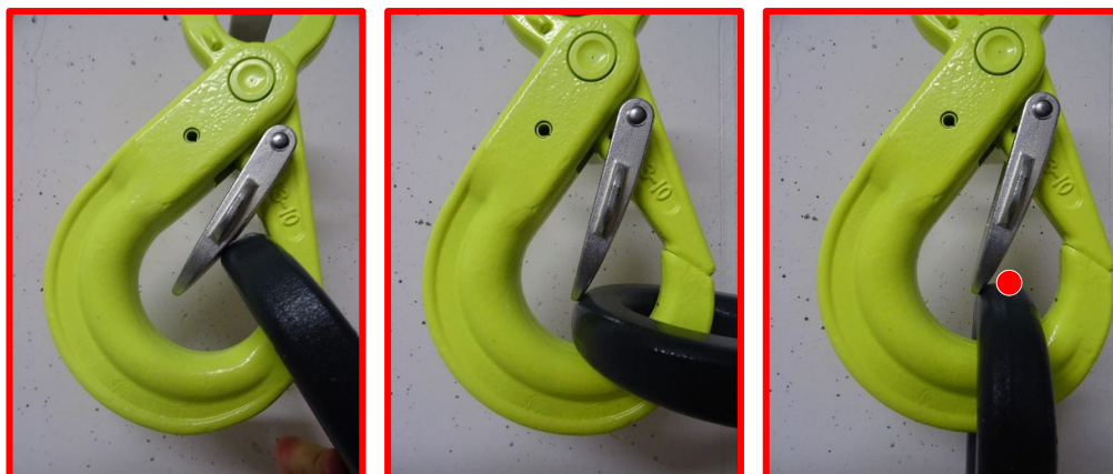
Fig. 15 – 17 : Utilisation inappropriée ! Si l'ouverture du crochet est fermée immédiatement après avoir inséré l'accessoire noir, le linguet de sécurité ne peut pas être correctement verrouillé.
