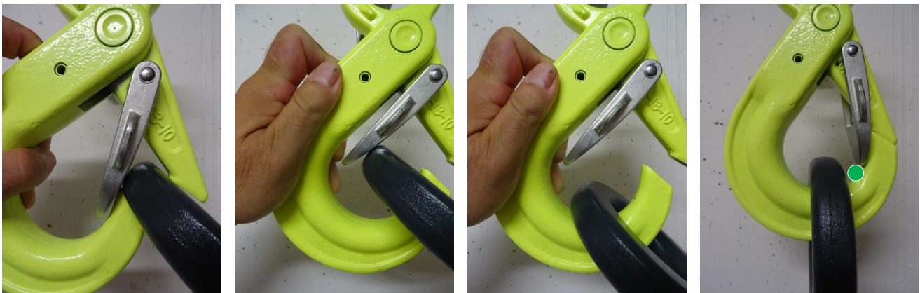
Fig. 11 – 14 : Ouvrir le crochet et insérer l'accessoire/la cosse. Maintenez le crochet ouvert et insérez complètement l'accessoire noir. L'accessoire n'est correctement placé que lorsque le 2 e linguet de sécurité est complètement fermé.
