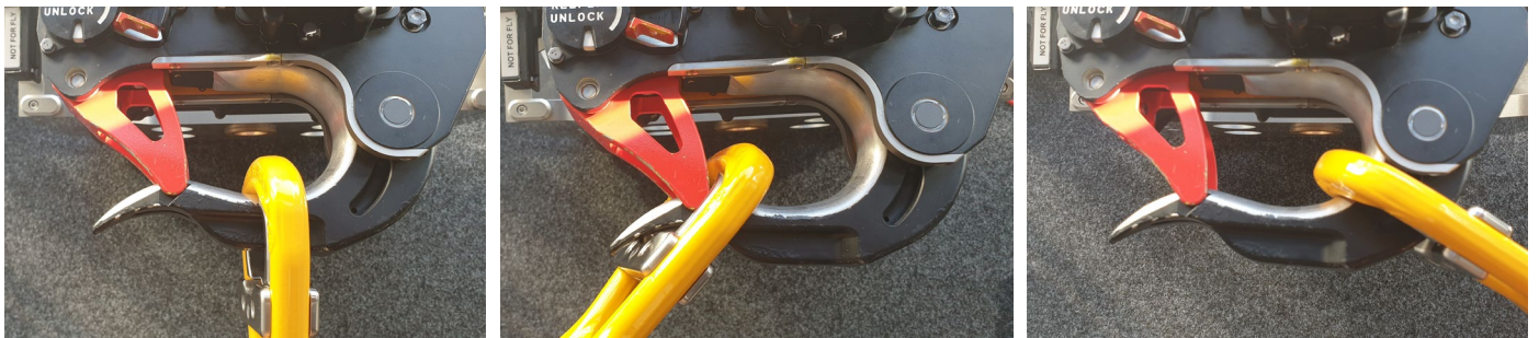
Fig. 18 – 20 : Accrochez le AM_NH90_SKG13 et vérifiez qu'il se déplace librement sans compromettre le fonctionnement du crochet principal.
